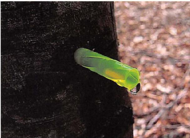
図 3-20 ブナの根圧測定。幹にパイプを埋め込み、パイプの端に圧センサーを取りつけて測定した。久保田光政撮影。
